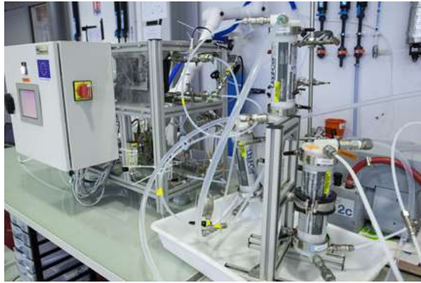
Photographie du pilote d'absorption gaz-liquide et exemple de configuration à 3 contacteurs
