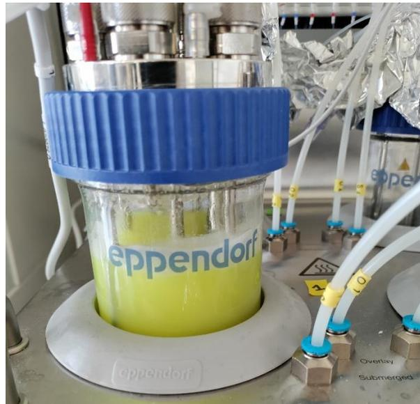
Figure 2 : Culture de *Escherichia coli* modifiée génétiquement dans le système DASbox®
