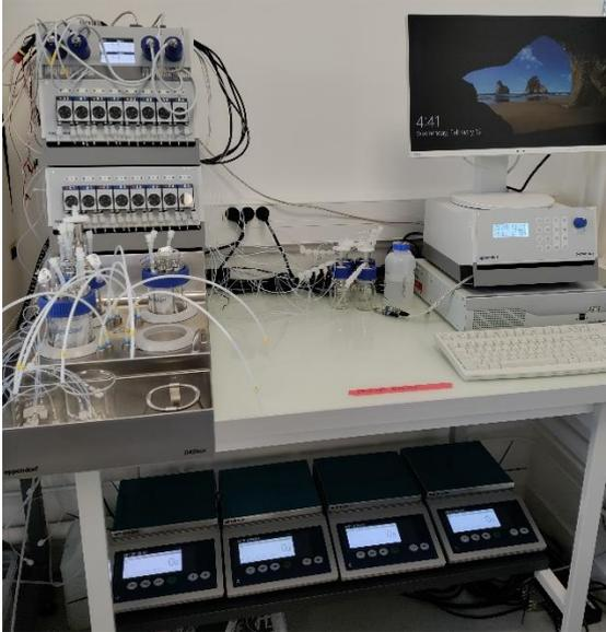
Figure 1 : Système de Mini-bioréacteurs parallèles DASbox®
