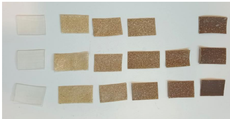
Bio-composites obtenus à partir d'amidon et de diverses concentrations de chènevotte.
