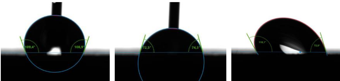
Fig. 4. Hystérésis d'angle de contact sur une surface hétérogène verre/PDMS : Mesures de l'angle d'avancée (gauche) et de recul (milieu) par la méthode de gonflement/ dégonflement d'une goutte d'eau, mesure par la méthode de l'inclinaison de la goutte (droite : ici le substrat est incliné ainsi que la caméra, ce qui explique que la surface reste horizontale sur l'image)
