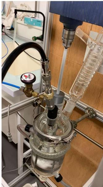
Dispositif d'amorçage plasma intégré à un réacteur de cristallisation agité
