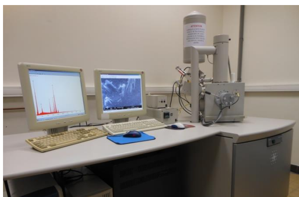
Microscope électronique à balayage environnemental FEI Quanta 200
