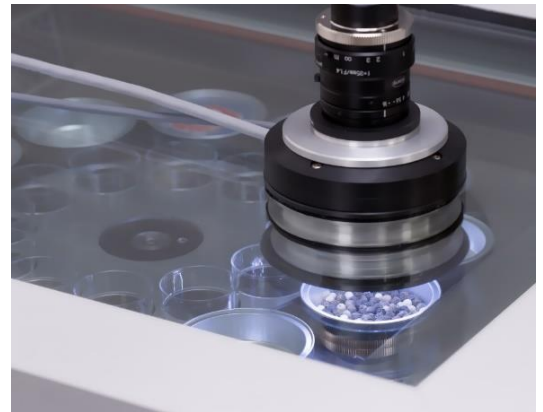
Pour imagerie des échantillons pendant la mesure DVS, un appareil photo numérique est installé au-dessus du carrousel de l'instrument SPSx.
