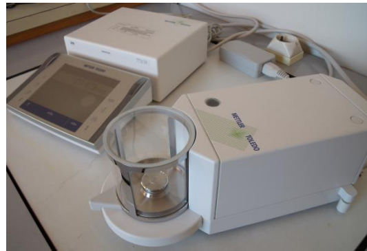
Microbalance utilisée pour une pesée des échantillons Pesées des échantillons solides : 2 - 3 mg (précision de 1 µg)
