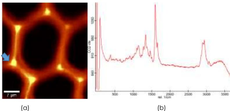
Figure 2. (a) Exemple de cartographie Raman sur une cellule de peuplier. Une bande est intégrée à  $1600\text{cm}^{-1}$  révélant des concentrations différentes en fonction de la position dans la cellule. (b) Spectre correspondant au point indiqué par la flèche.
