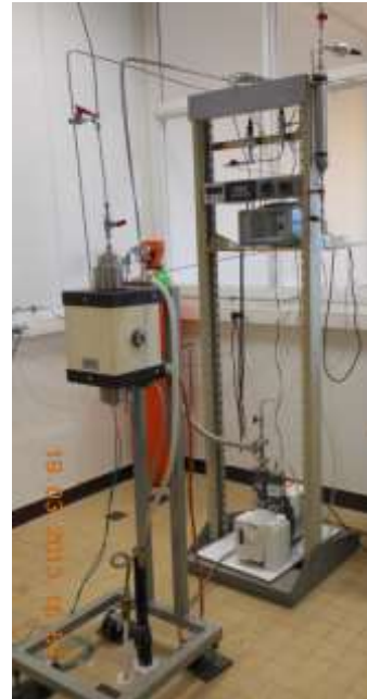
Représentation schématique du dispositif expérimental pour les mesures de mouillabilité (méthode de la chute de goutte) à gauche, photographie du montage à droite.
