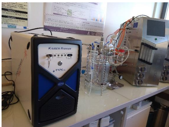
Figure 1 : Spectromètre Raman et un bioréacteur instrumenté
