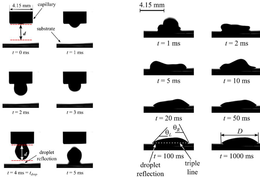
Exemple du mouillage d'un acier par Zn-0,2 wt.%Al-0,015 wt.% Fe à 450 °C : Séquence d'images utilisée pour déterminer la vitesse d'impact de la goutte sur le substrat solide (la distance  $d$  est mesurée entre la position de la goutte qui sort du capillaire et la position de la goutte juste avant son contact avec le solide (à gauche) ; Étalement de la goutte sur l'acier à 450°C (à droite). M.-L. Giorgi, J.-S. Diawara, M. Rivollier, H. Duval, A. Koltsov. ISIJ International, 58 (2018) 1592-1598.
