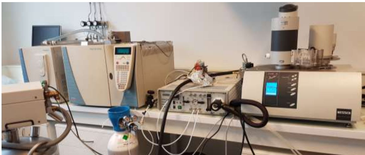
Figure 1. Couplage de la thermobalance Netzsch STA 449 avec la technique de chromatographie en phase gazeuse-spectrométrie de masse (CPG-SM)
